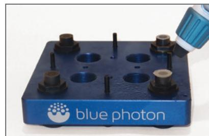
手持式加圧スチーマーによって、グリッパーとワークの硬化剤残滓を除去。
