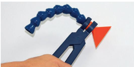
オプションの専用プライヤーを利用して頂くと、各ピースを簡単に組み付ける事ができます。ピースの取り外しもできます。ピースの組み合わせによっては組み付けまたは取り外しができないことがあります。78004はピースの取り外しには使用できません。
