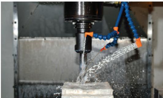
必要とされるクーラントやエアブローの吐出状態に対応出来るように、ホース径／吐出孔径／L型／平面形状等の多数のオプションピースを用意しています。
