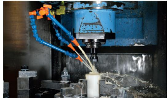
一旦作られた形状は機械振動などにより簡単に崩れたりすることはありません。また曲げても断面積は変化しない工夫により、クーラント通過による変形量は最小です。
