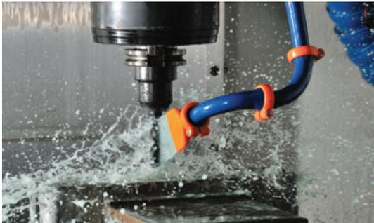
ロックラインクーラントホースは手で自由に曲げることが出来るので、自在な形状を簡単に作ることが出来ます。これにより加工品種の変更等に柔軟に対応します。
