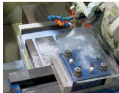
工業用ガラス・セラミックの研削加工
