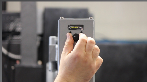
標準のパネル取付式ノズル姿勢調節ノブ。CNC制御盤の任意の固定位置もしくはその付近に取り付けることができます。
