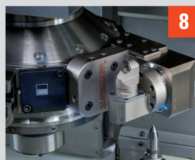
クイックチェンジ式ツールホルダの設置
