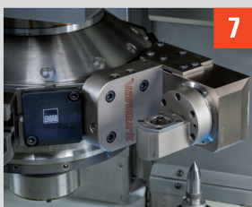
クイックチェンジ式ツール取付部の設置
