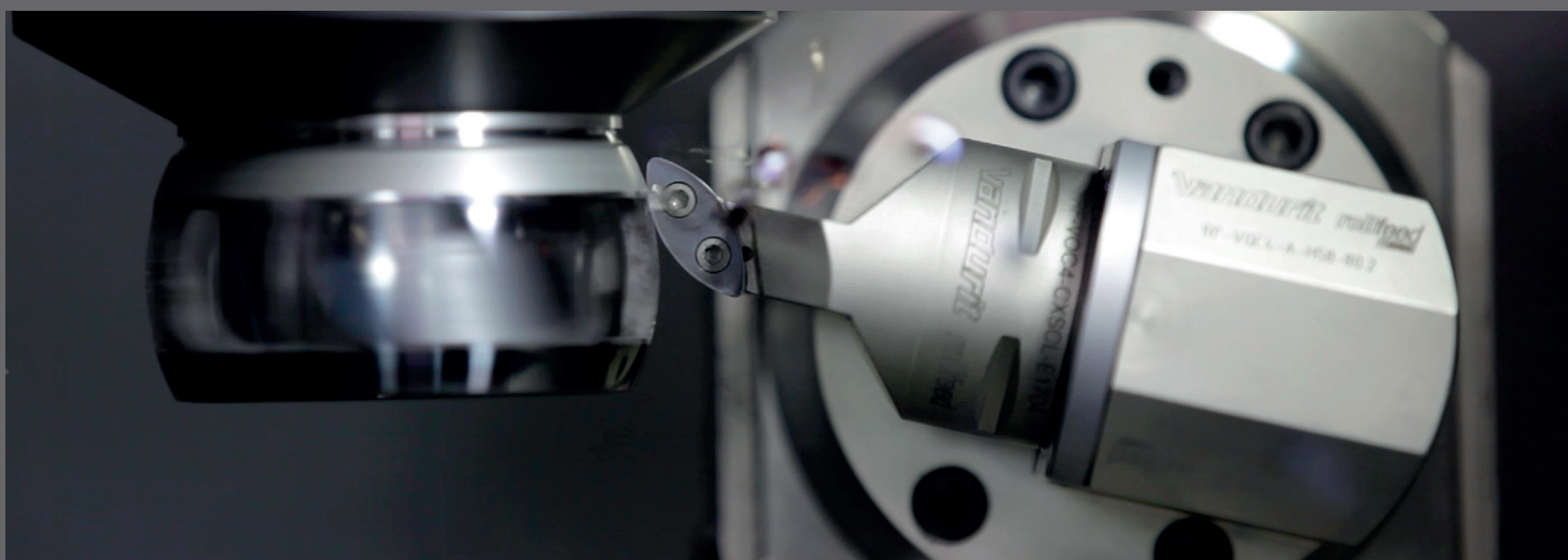
ボールゲージ（高硬度ワーク）のターニング：最終仕上
