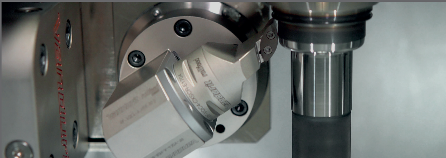
ボールジョイント（高硬度ワーク）のターニング：最終仕上、旋条発生無し
