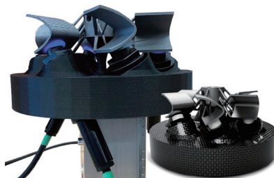
積層造形後の複雑形状加工
